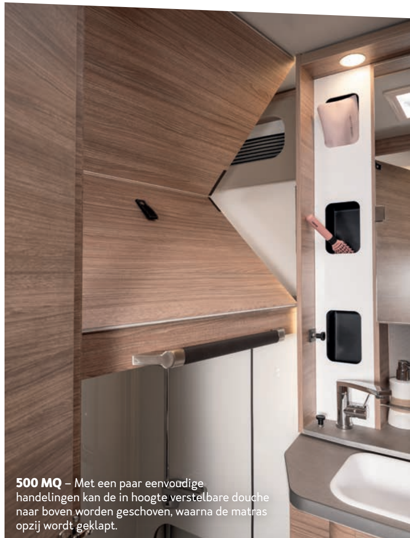
500 MQ – Wanneer de douche in de bovenste positie is geschoven, wordt het een volwaardige douchecabine met een opklapbare wand en een maximale stahoogte van 1,90 meter.
